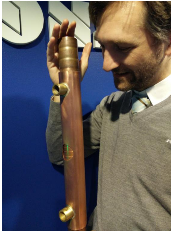
Figur 6.2 Stående rörvärmväxlare (Foto: Ian Hostetter).
