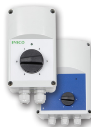
5-stegs transformator VR0,8 och VR2,2 För hastighetreglering av fläktar. 80, 110, 140, 170 & 230V
